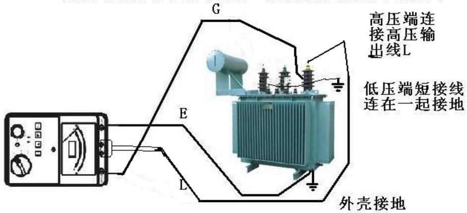
变压器高压端对地绝缘
