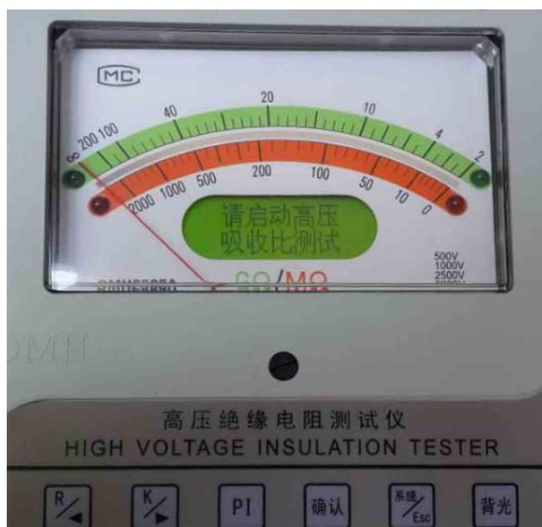
启动高压测试后，如下图图示当前测试时间进行了20S，测试电压为1.00kV，测试电阻1.02 G $\Omega$ ，15秒值已锁定1.02 G $\Omega$
