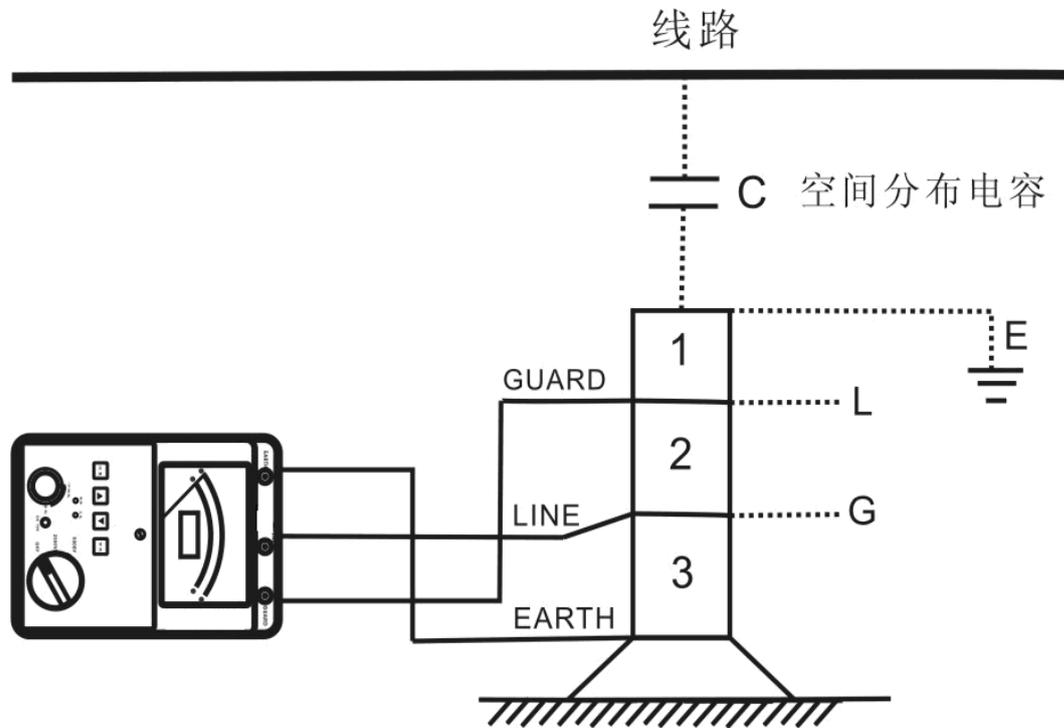
避雷器、耦合电容测试，利用屏蔽端屏蔽掉干扰
