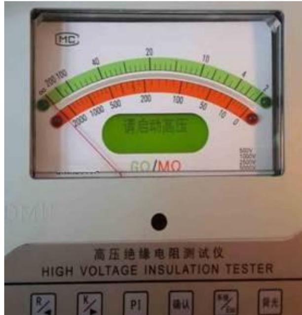
按菜单提示启动高压输出键（13）输出高压测试
