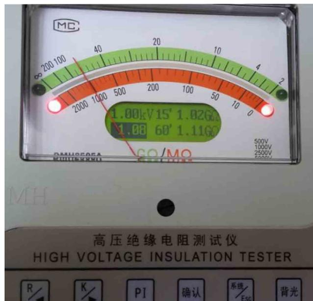
图示测试电压1.00KV, 15秒测试电阻值1.02 GΩ, 60秒测试电阻值1.11 GΩ, 计算测试吸收比1.08。如此时按“ESC”键退出可自动保存当前测试结果和当前测
